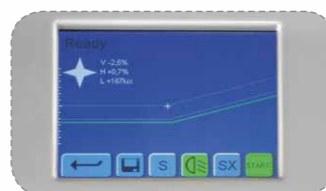
3 • Visualizzazione della posizione del fano anabbagliante • Control visual de la posición de luz de cruce • Visual check on low beam position • Sichtkontrolle auf Abblendlicht Position
