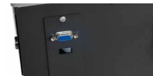
• Connessione seriale RS232 • Conexión puerta serial RS232 • RS232 serial connection • RS232 serielle Schnittstelle
